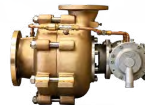
TYP: RUBERG R2-280 rodzaj: niskociśnieniowa materiał: brąz wydajność: 5 000 - 6 000 l/min - 10 bar
