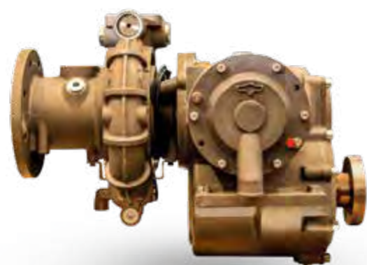
TYP: RUBERG E15 rodzaj: jednozakresowa materiał: brąz / aluminium * wydajność: 1 500 l/min - 10 bar
