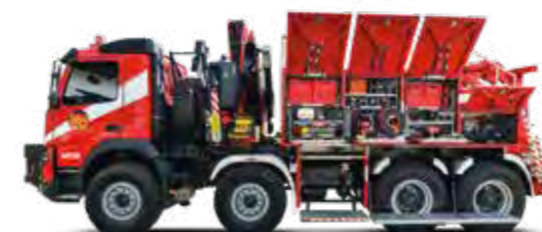
SAMOCHÓD RATOWNICTWA TECHNICZNEGO Z URZĄDZENIEM HOLOWNICZYM 8x4 VOLVO
