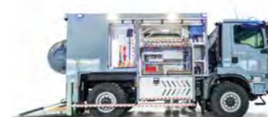
SAMOCHÓD SPECJALNY DO PRZEWOŻENIA ŁADUNKÓW WYBUCHOWYCH WYPOSAŻONY W GAZOSZCZELNY POJEMNIK PRZECIWWYBUCHOWY 4x4
